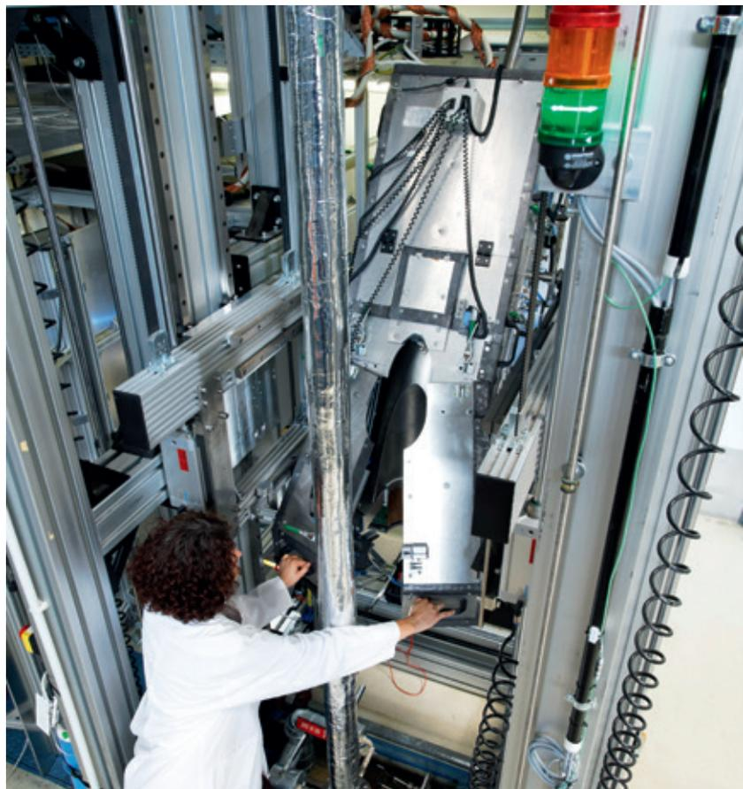
TOPFLOW-Anlage: Drucktank (links), ROFEX-Scanner (rechts)
