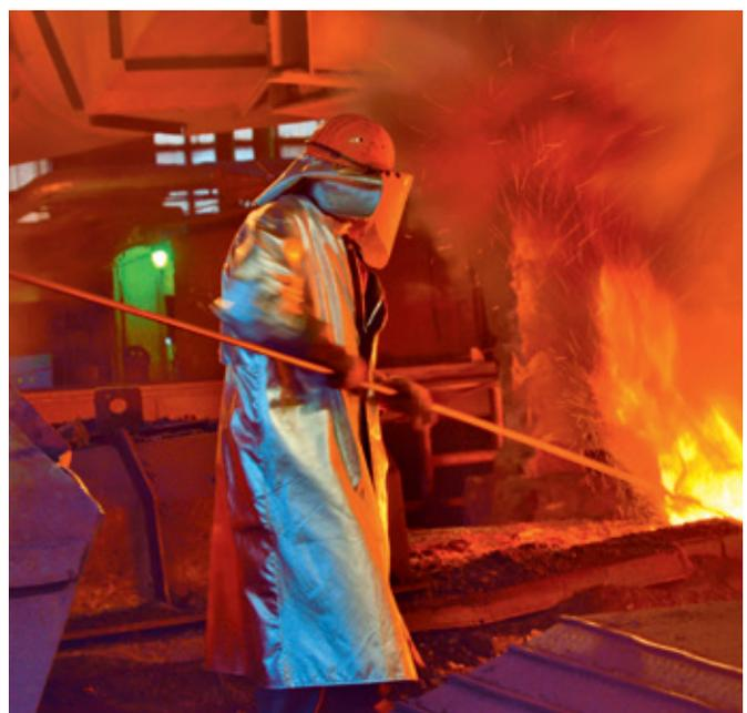
Links: Das HIF betreibt eine Pilotanlage für die Wertstoffgewinnung mittels Flotation. Rechts: Der Strangguss von Stahl ist ein äußerst energieintensiver Prozess. Das Institut für Fluiddynamik hat sich mit seinen grundlegenden und angewandten Arbeiten auf diesem Gebiet einen Namen gemacht und arbeitet zur Prozessoptimierung eng mit Industriepartnern zusammen.
