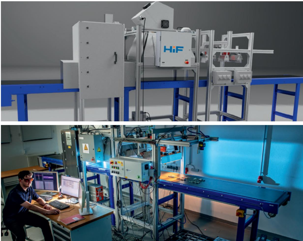
Abb. 37: Demonstrator für die multi-parametrische Charakterisierung von komplex zusammengesetzten Rohstoffen über Kamera- und Sensorsysteme. Oben: Schematische Visualisierung; unten: Foto der Versuchsanlage
