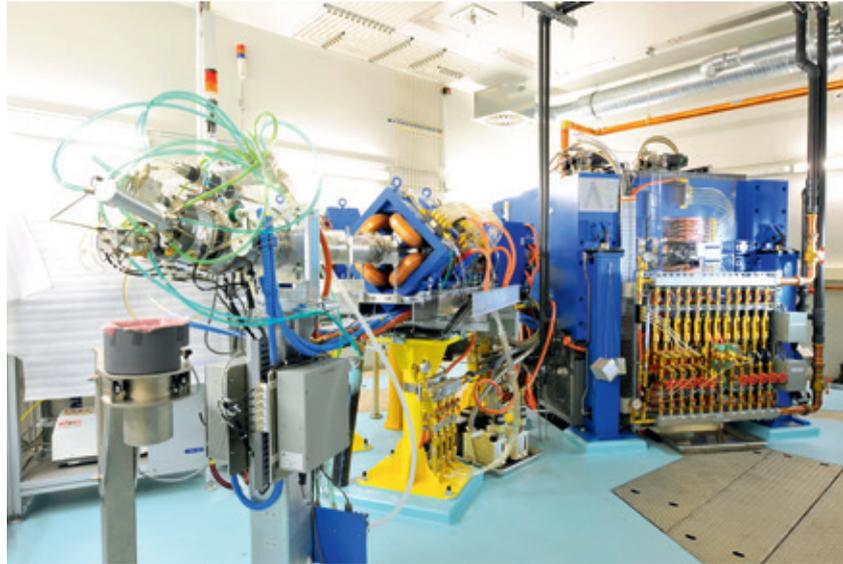
Das leistungsfähige Zyklotron (rechts) liefert die radioaktiven Ausgangssubstanzen, aus denen unter medizinischen GMP-Bedingungen Radiotracer zur Diagnose von Krebserkrankungen hergestellt werden können (links).
