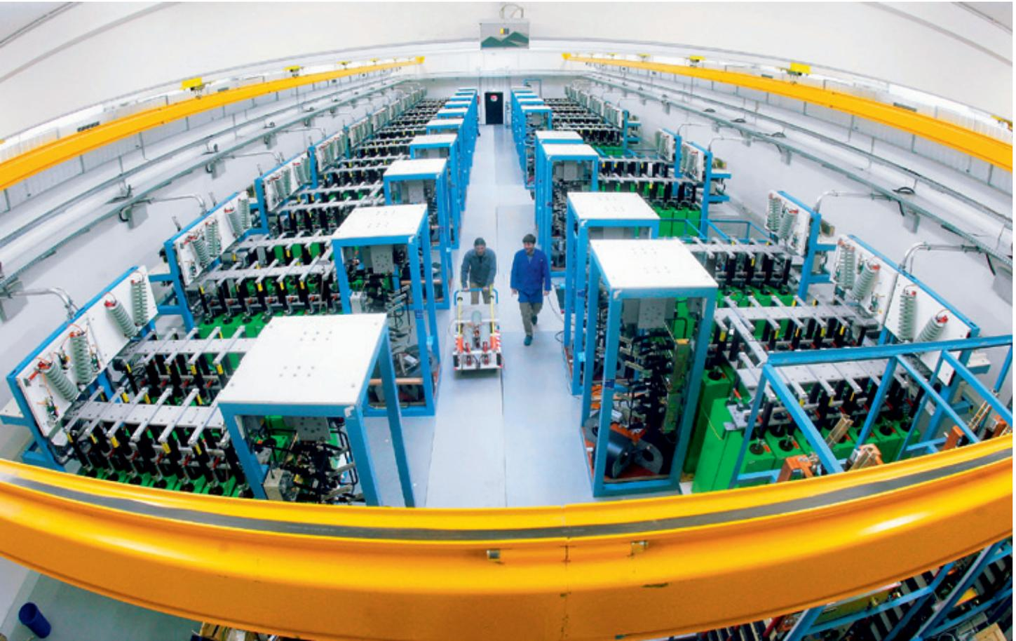
Die weltgrößte Kondensatorbank speichert die Energie, die für die Erzeugung der hohen Magnetfelder zur Erforschung neuartiger Materialien benötigt werden.
